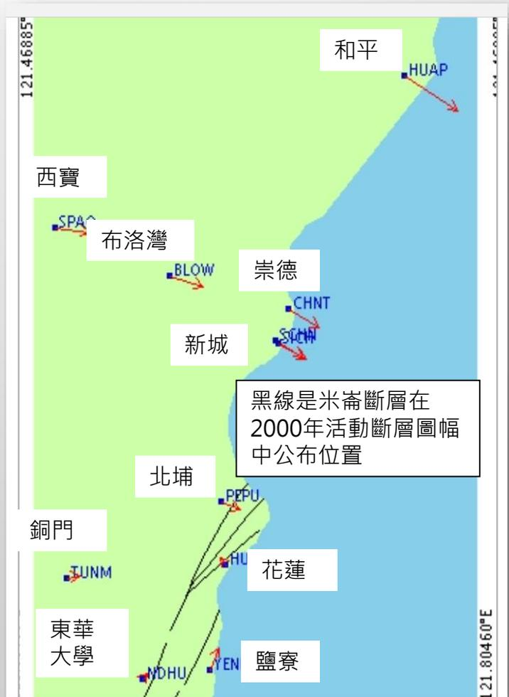
圖1.米崙斷層位置(2000年活動斷層圖幅)與原先GPS連續站位置
